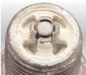
Dépôts résiduels de gas d'enfouissement Depósitos de gas de vertedero
