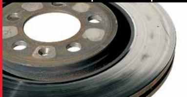
**Quale è la causa?** Il montaggio scorretto della pinza e/o delle pastiglie può far sì che le pastiglie non risultino inclinate dello stesso angolo rispetto al disco, usurandosi quindi con tempi diversi sui due lati. Le macchie bluastre sono generate da un elevato surriscaldamento localizzato.
