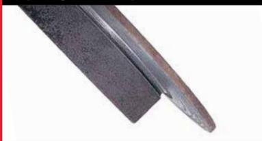
**Quale è la causa?** Un'usura estrema di pastiglia e disco può causare il movimento del supporto metallico all'interno della pinza. In questo caso, la il supporto metallico della pastiglia usurata si è staccata dalla sua sede all'interno della pinza, provocando una scanalatura tra la superficie del disco e della campana.
