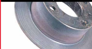
**Quale è la causa?** Un'usura eccessiva o completa delle pastiglie mette il supporto metallico in contatto con il disco (metallo su metallo). Questo produce scanalature sulla superficie del disco.
