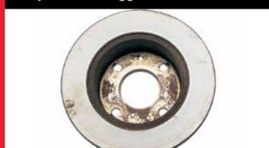
**Quale è la causa?** Contaminazione della superficie del mozzo. Questo causa un disallineamento durante il montaggio, portando a un contatto irregolare tra le superfici del disco e della pastiglia e a un'irregolare usura del disco.
