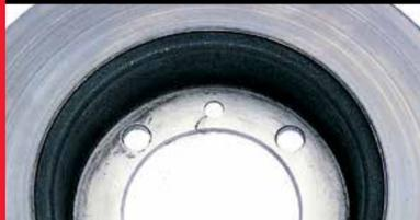
**Quale è la causa?** Coppia di serraggio eccessiva applicata sulla vite di posizionamento.
