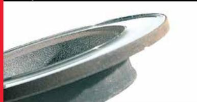
**Quale è la causa?** I dischi non sono stati ispezionati regolarmente o sostituiti al momento corretto.
