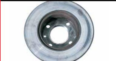
**Quale è la causa?** L'eccessiva eccentricità del mozzo e il contatto non liscio tra disco e pastiglia generano una vibrazione che causa il calore localizzato.
