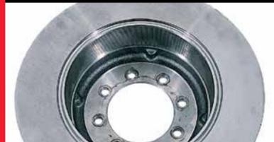
**Quale è la causa?** Sequenza di serraggio non corretta, coppia di serraggio applicata non sufficiente.
