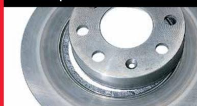
**Quale è la causa?** Stress meccanico causato dal disallineamento e da un errato assemblaggio/posizionamento della pinza e del disco. Questo causa un'usura asimmetrica della superficie di frenata.
