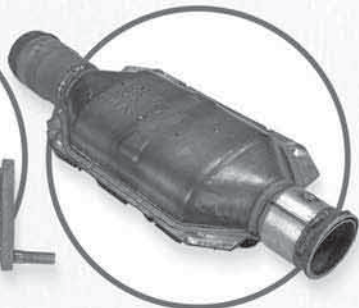
SUSTRATO SOBRECALENTADO / ENVOLTURA DESCOLORIDA
