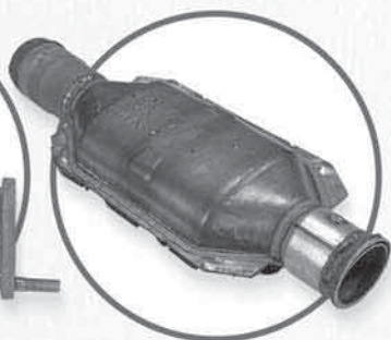
SUBSTRAT SURCHAUFFÉ / COQUE DÉCOLORÉE
